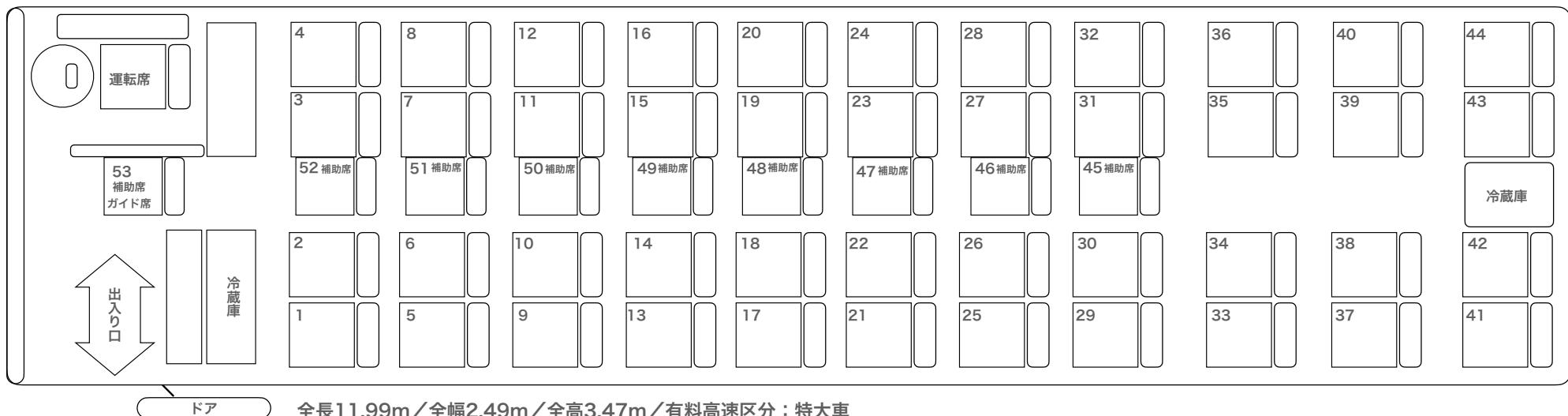
全長11.99m/全幅2.49m/全高3.47m/有料高速区分：特大車
