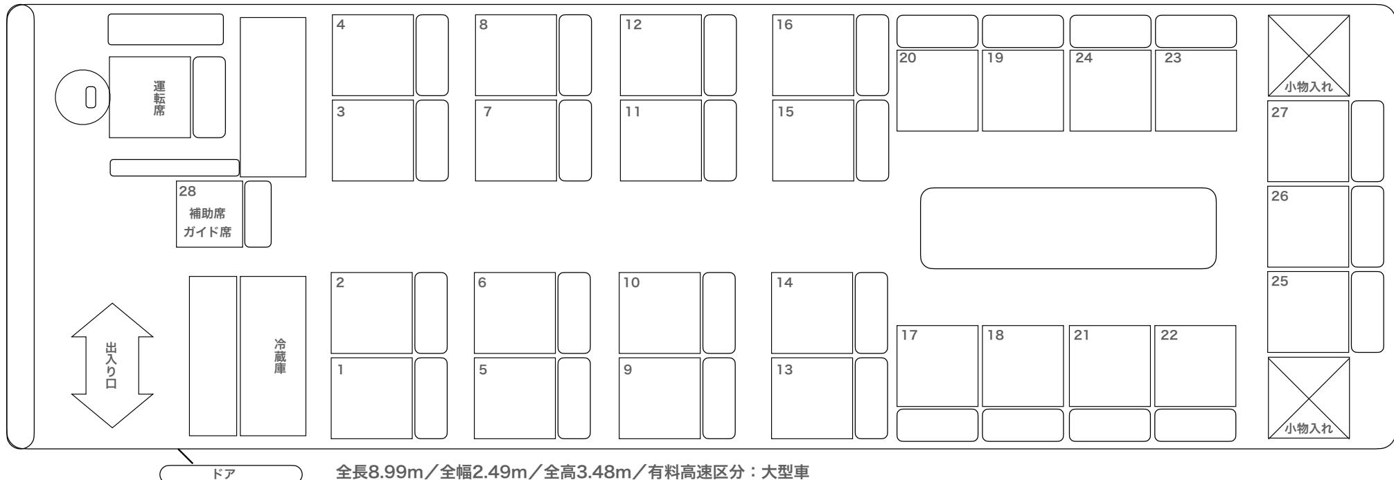
全長8.99m／全幅2.49m／全高3.48m／有料高速区分：大型車
