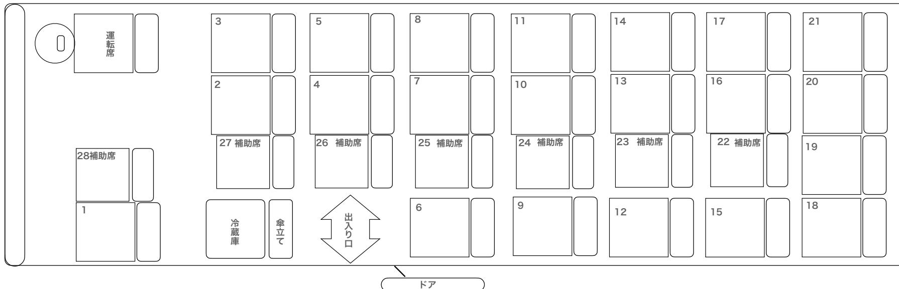
全長6.99m／全幅2.03m／全高2.75m／有料高速区分：中型車
