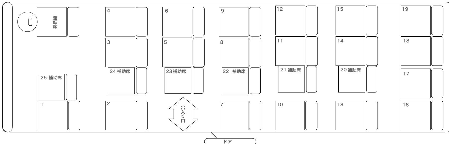
全長6.25m／全幅2.03m／全高2.58m／有料高速区分：中型車
