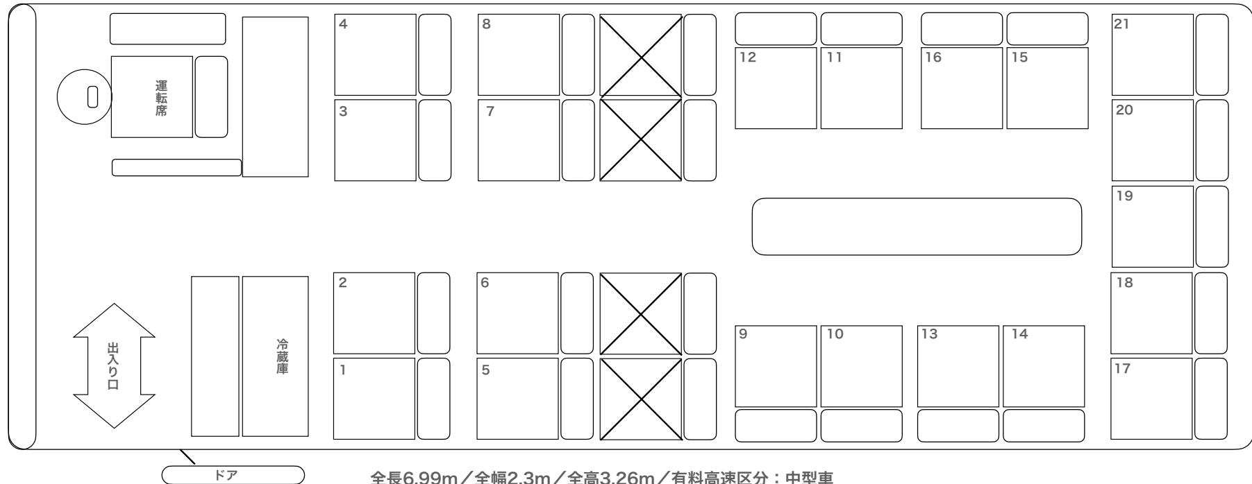
全長6.99m／全幅2.3m／全高3.26m／有料高速区分：中型車
